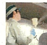
光触媒等車内抗菌施工
